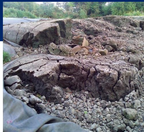
La consolidation des solides à l'intérieur des unités **TenCate Geotube®** assure une diminution du volume des sédiments de l'ordre de 90 %. Une fois rempli, le contenant peut alors être chargé et évacué pour être traité ou revalorisé.
